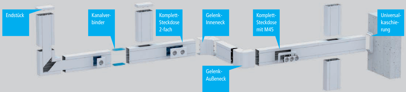
Beispielabbildung Geräteinbaukanal-System BR 60x130 mit 80 mm Oberteil Geräteeinbau von 80 mm Standard-Flächengeräten und von M45 Einbaugeräten aus dem M45 Modulbaukasten mittels Adapterrahmen möglich
