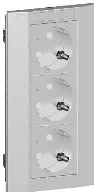
Vorkonfektionierte 3-fach Steckdoseneinheit, bestehend aus Montageträger, Abdeckrahmen mit Beschriftungsfeld 8x40mm und einer 3-fach M45 Steckdose 45° schräg, Leitungsanschluss über Steckklemmen, 2-polig, 16 A/250 V~, mit Verbindungsklemmen nach VDE 0620, geeignet für 3 Winkel- oder Flächenstecker, mit erhöhtem Berührungsschutz gemäß VDE 0620, zur Installation in Brüstungskanälen und Installationssäulen mit einer 76,5 mm breiten Befestigungsspur, für die vertikale Geräteinstallation.
